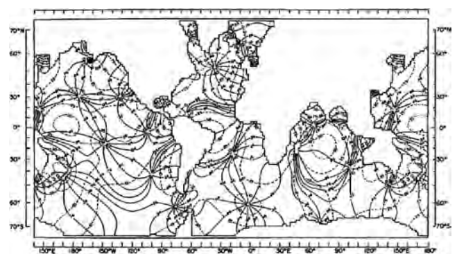
図9 月による潮汐パターンの数値計算の例。実線は満潮時刻 (GMT)、破線は振幅 (cm) を表す。
