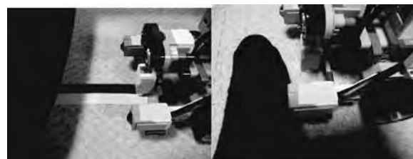
図11 超音波センサとタッチセンサの検知方法, (a) 左図は超音波センサ, (b) 右図はタッチセンサ
