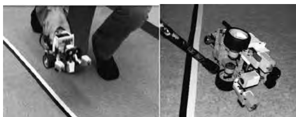
図12 “イーグル 113” が持ち去られる・破壊される例 (a) 左図は持ち去り, (b) 右図は杖で叩き飛ばし。
