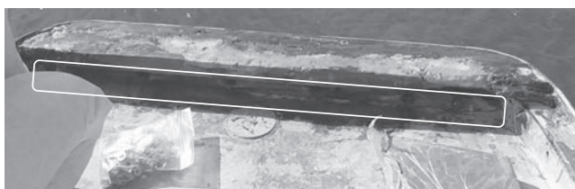
図 6 船首の木材と船体の隙間
