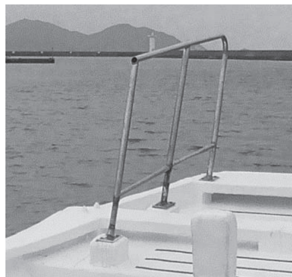
図 22 左舷側手すりと滑り止めテープ
