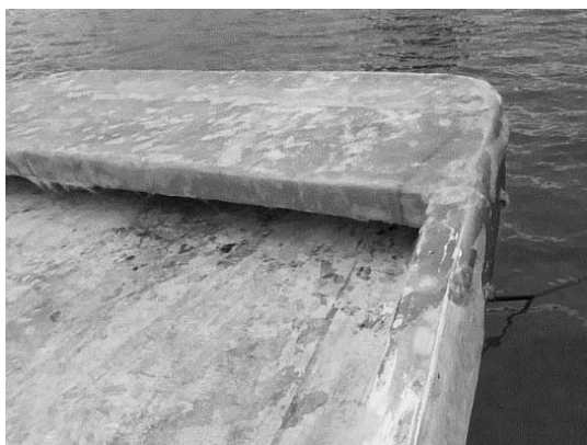
図 12 FRP のサンディングとパテ埋め
