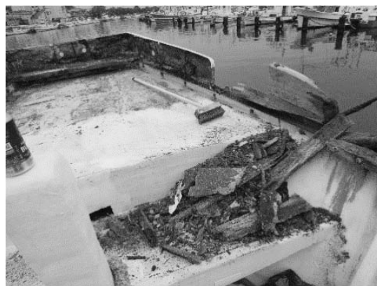
図 3 腐敗した内部の木材
