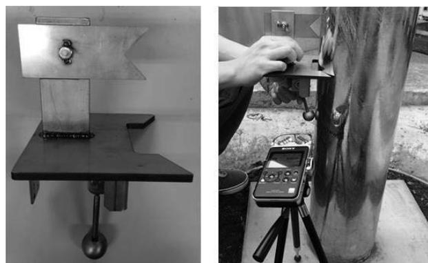
(a) 振子型ハンマ (b) 振子型ハンマの打撃方法
